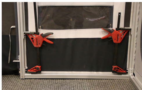
*1 - Spänn upp frontväggen sektionvis med att sätta tvingarna på övre delen mellan tvärstaket och överliggaren.
