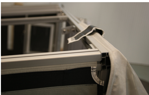
*4 - Fäst båda takstolar genom att använda en av de ilagda bultbrickorna i C-vinkeln på överliggaren.
