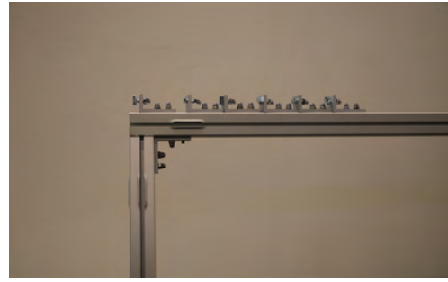
*5 - Lägg i de förberedda B-vinklarna på ovansidan av överliggaren, alla ska peka åt samma håll förutom en.
