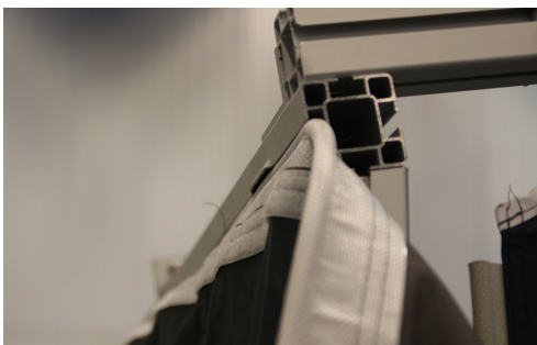
*2 - Dra ut frontväggen försiktigt tills att takstolarna är kant i kant med frontväggens överliggerare.
