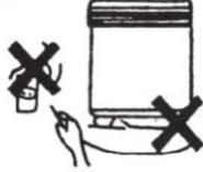
Maskinen kan rengjøres med en myk fille og et nøytralt rengjøringsmiddel. Bruk aldri etsende eller alkaliske midler!
